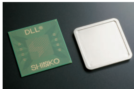
フリップチップタイプパッケージ（左）とヒートスプレッダー（右）
