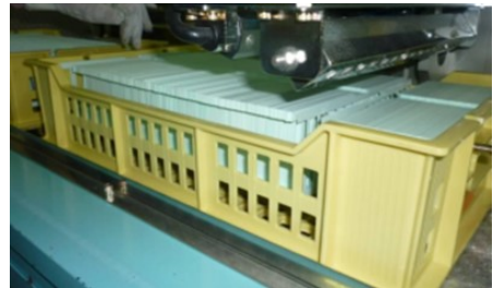
〔改善後の層間紙洗浄設備〕
